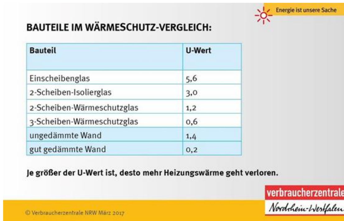
Abbildung 24: Bauteile im Wärmeschutz-Vergleich, Quelle_ Verbraucherzentrale NRW
