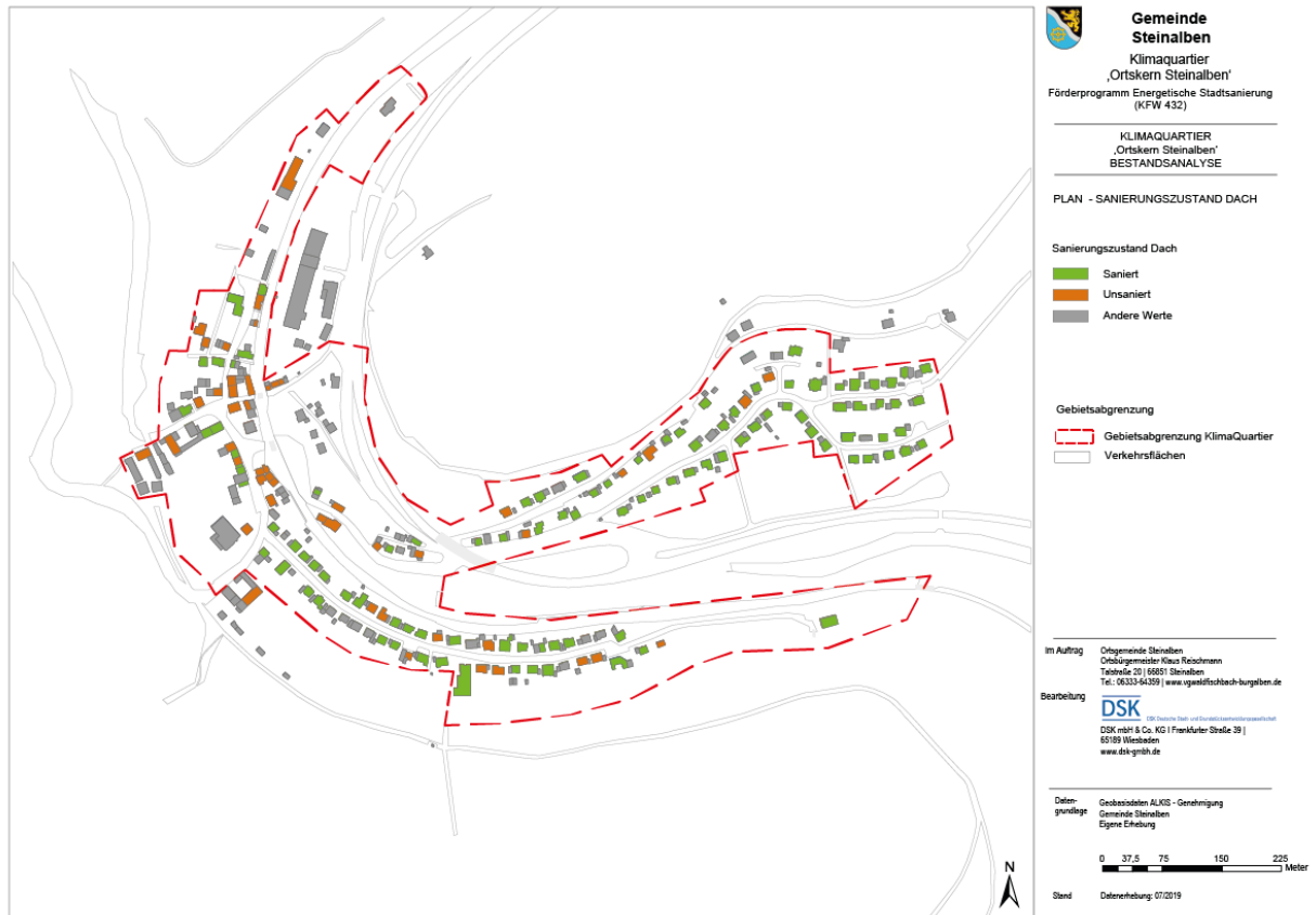
Abbildung 30: Dachsanierung Quelle: Eigene Darstellung
